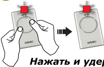
Одновременно нажать кнопки P1 и P2 на пульте "мастер" и отпустить кнопки когда индикатор замигает (через 1-2 секунды). В течение последующих 10 секунд выполнить действия:
