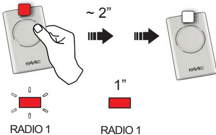
Нажать и удерживать кнопку пульта, выбранную для управления створкой (например P1) - диод пульта должен гореть постоянно. По истечению не более 2х секунд индикатор RADIO1 загорится постоянным светом на 1 секунду. Отпустить кнопку P1.
