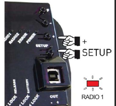
Подать с пульта 3-4 импульса длительностью до ~3 секунд каждый. Управление воротами будет выполняться, согласно логического алгоритма "Е". Для изменения алгоритма и режимов работы и для записи дополнительных пультов - обратиться к полным инструкциям на плату E721 и пульты.
